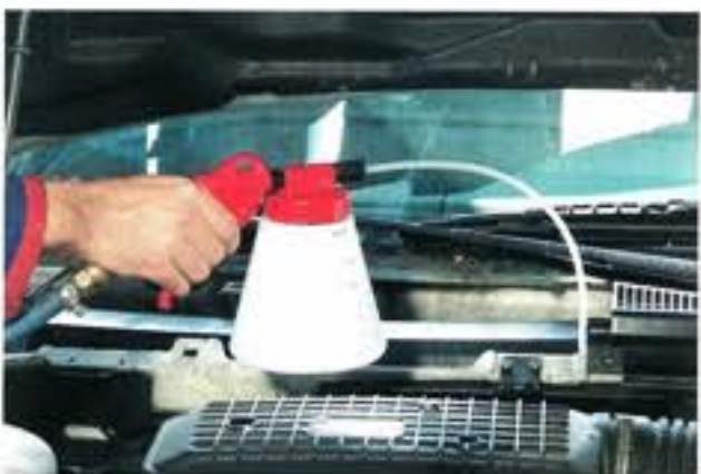
Taki system dezynfekcji układów klimatyzacyjnych przeznaczony jest raczej dla profesjonalnych użytkowników
