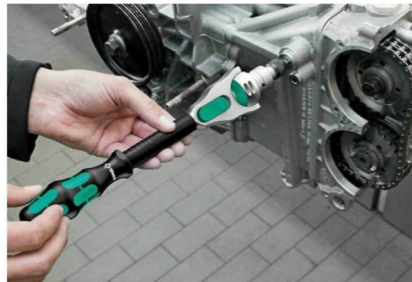
Grzechotka Wera Zyklop Speed 8000 C. Pokręto zapadkowe (grzechotka) do kluczy nasadowych 1/2", 1/4", 3/8" okazuje się przydatne do prac warsztatowych i serwisowych.
