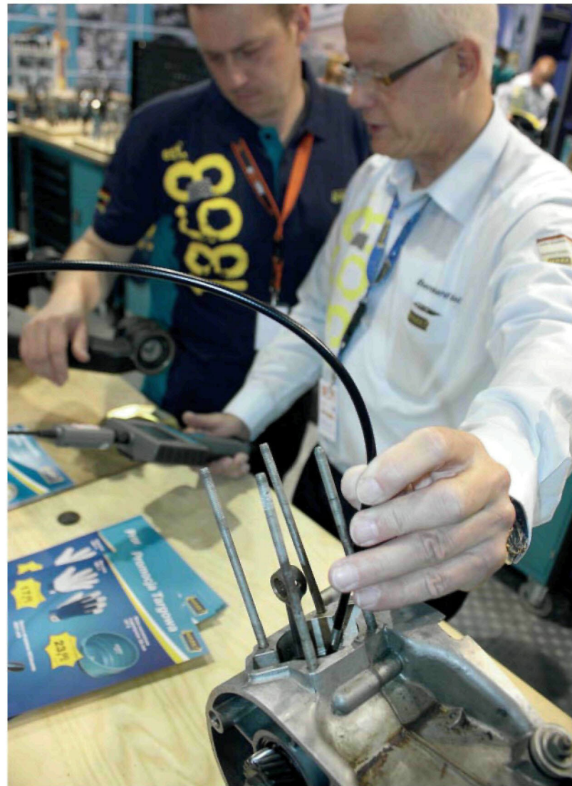
Sonda marki Hazet – rozwiązanie na ciasno zabudowane podzespoły w komorze silnika.
